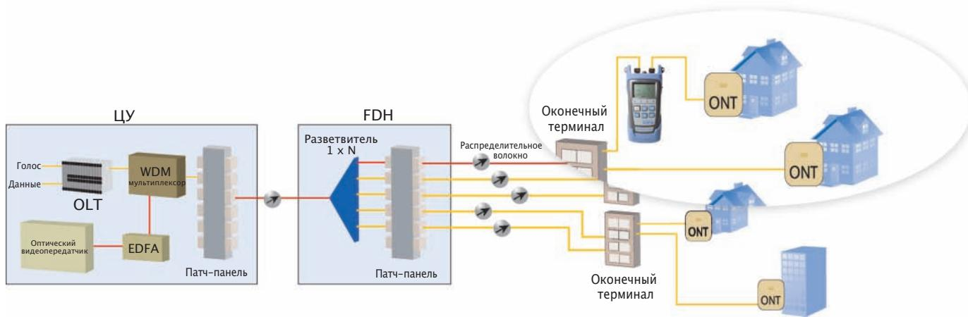
■ Типичное применение фильтра для сквозного пропускания сигнала в сети PON.
